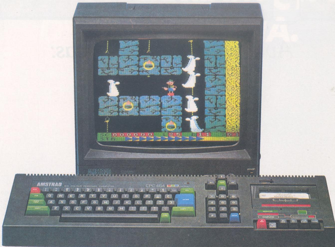
indicador de encendido en la unidad central disipa toda duda sobre el funcionamiento o no del ordenador. La disposición del teclado corresponde a los criterios en boga actualmente: teclado numérico separado, bloque de teclas de edición, zona alfabética poco sobrecargada, teclas de control coloreadas, tabulación, tecla ESC, tecla de validación (ENTER) superdesarrollada.
