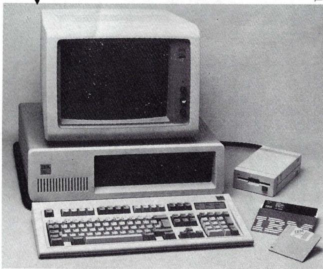
Entre las opciones que pueden complementar esta configuración básica destacan principalmente la posibilidad de incrementar la memoria de usuario hasta 8,6 MB y la instalación adicional de un disquete de media altura a elegir entre las tres opciones siguientes: de 1,2 MB y 5,25 pulgadas; de 360 KB y 5,25 pulgadas, o de 720 KB y 3,5 pulgadas.
