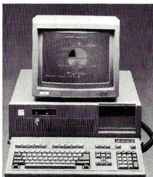
monocromático o color, salida lápiz óptico, disco flexible de 1,2 Mb, disco duro de 21 Mb, salida serie RS232 y paralelo Centronics.
