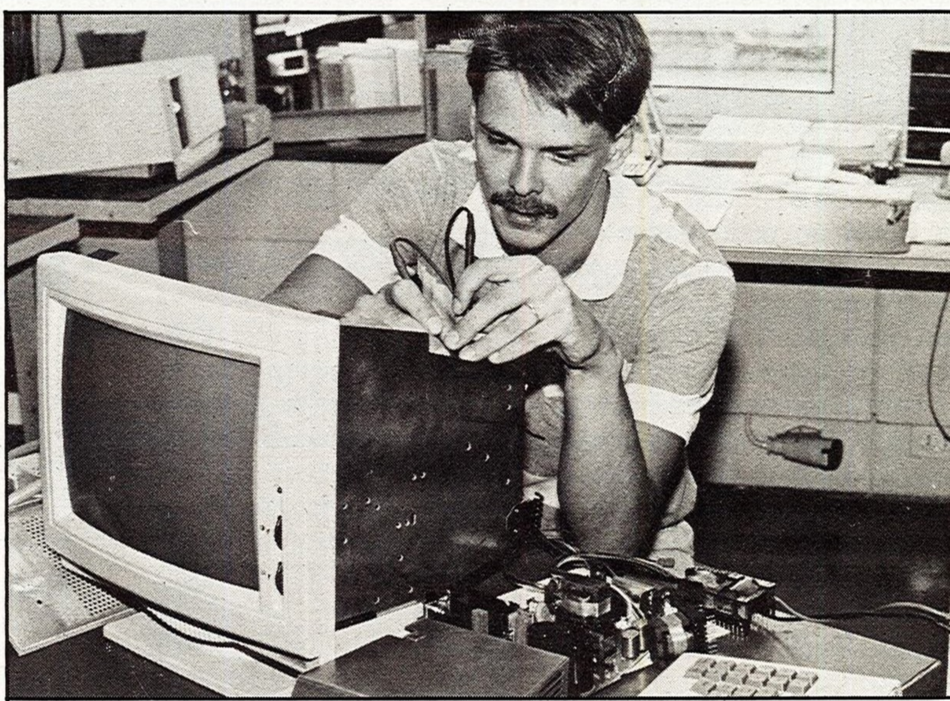
SETI:n koestuslaboratoriossa tehdään muutakin kuin sähköisiä testejä. Tässä annetaan Mikromikron kuoreen mekaanisia iskuja, joilla varmistetaan, että sähkötekniikka on ulkopuolelta riittävän hyvin suojattu.
