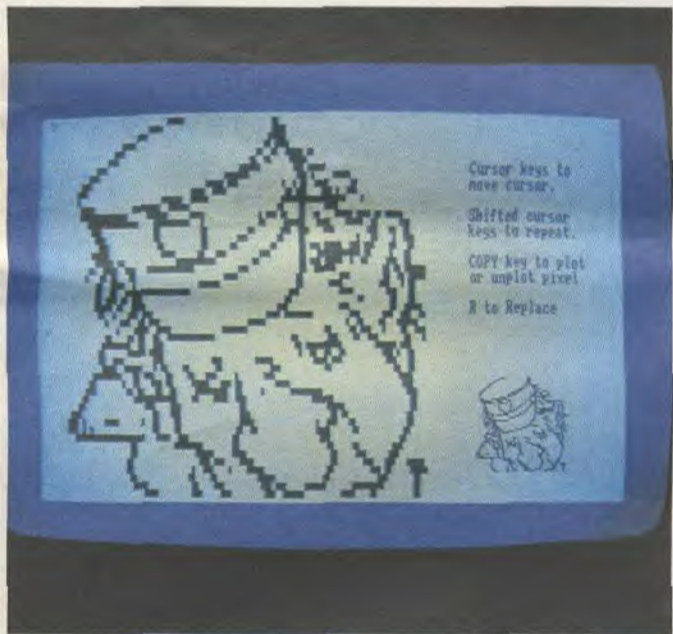
Exemple de zoom sur une partie de l'écran. La correction ou le remplissage de l'image est réalisée pixel par pixel, le résultat, taille réelle, affiché en permanence en bas, à droite de l'écran.
