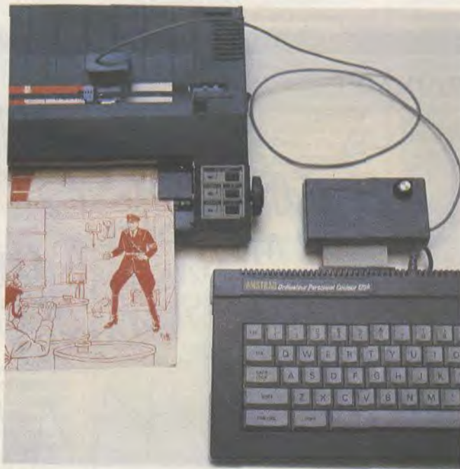
L'interface se connecte sur le port d'extension et le boîtier sur la tête d'impression de l'imprimante.
