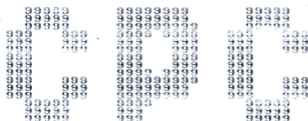
Enigme binarisée par seuillage binaire avec seuil = 4 après érosion-dilatation.
