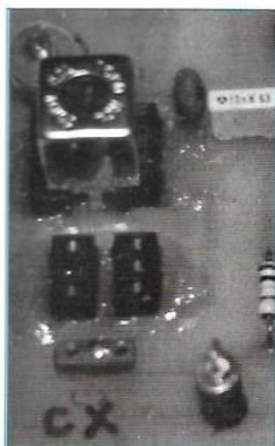
Gros plan sur les supports de transformateurs
