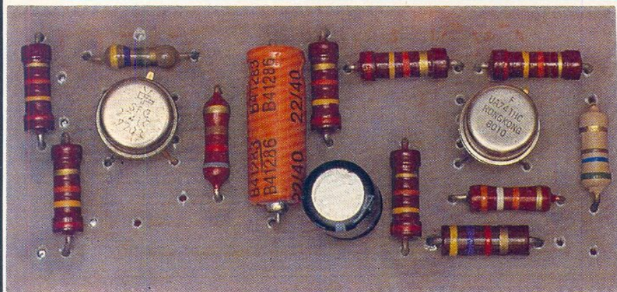
Ce module « hybride » permet le fonctionnement simultané d'un micro et d'un haut-parleur sans « effet Larsen ».
