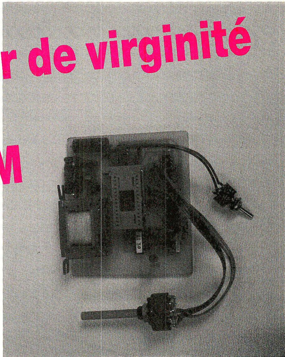
Minitel. Les seuls matériels de développement à posséder sont un effaceur d'EPROM à UV et un testeur de virginité. C'est ce dernier appareil que nous vous proposons de réaliser.
