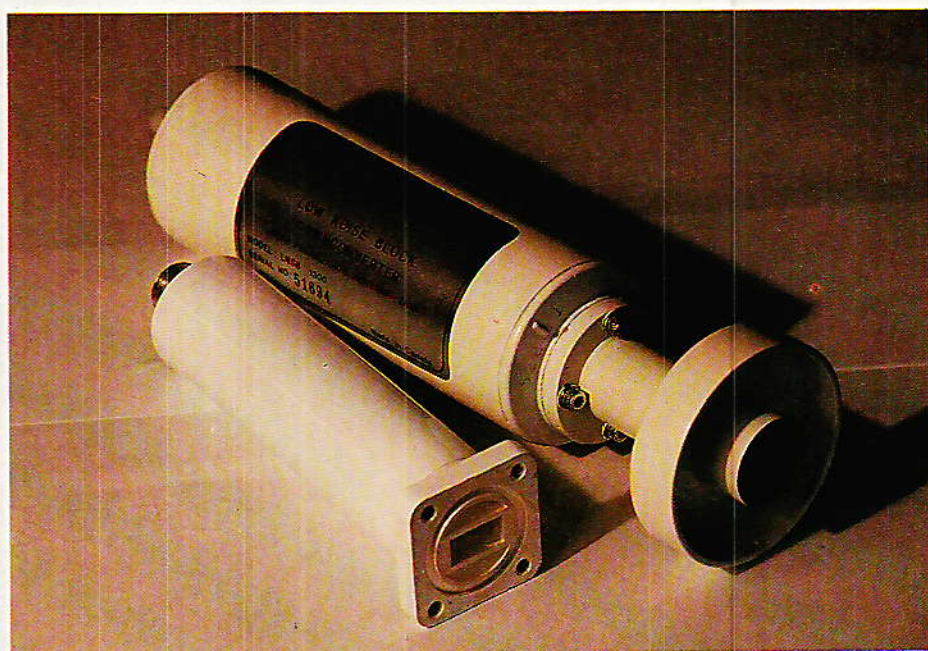
Figure 3 - Convertisseurs micro-ondes. A gauche, monopolarisation RTC, à droite, bipolarisation BEL-Tronics.
