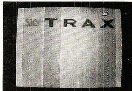
Réception de faisceau ouest de l'EUTELSAT I F1 - 13° Est à FES avec une parabole de 1,80 m Ø. L'image présente des traces de clics, vu le site à - 8 dB du PV.
