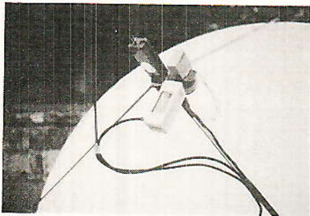
Réception 11 et 12 GHz. L'ensemble source, polariseur, convertisseur 11 GHz est placé en déport.
