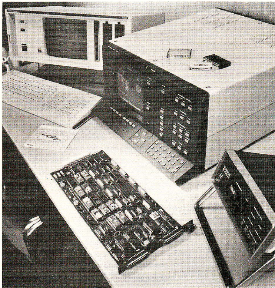
La carte PM 8851/20, interface RS 232 C, permet une liaison directe de l'analyseur logique à un micro-ordinateur (doc Philips).
