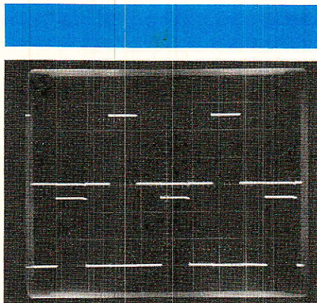
5 V/div 5 ms/car Signaux de commande des HEXFET
