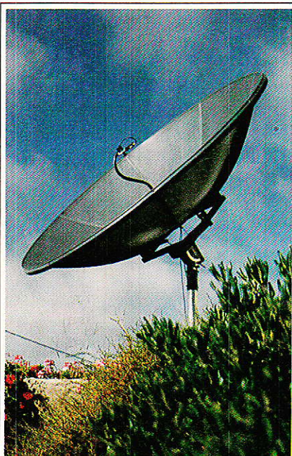
Aspect de la monture fixe - ► Parabole de 2,40 m. ◄ Parabole de 3,00 m de Ø avec monture équatoriale. Source - polariseur - tête. ►
