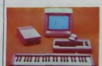
connectables au C64 et permettant de passer du stade de "bidouilleur" à celui de compositeur (ou d'interprète). En effet, il devient inutile de savoir jongler avec les Poke et les adresses mémoire pour pouvoir profiter pleinement des multiples capacités de synthèse de sons du C64. Le clavier branché, vous disposez de quatre octaves d'étendue et vous avez accès aux trois canaux du micro-processeur qui gère les sons sur le C64.
