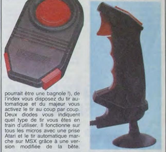
pourrait être une bagnole !), de l'index vous disposez du tir automatique et du majeur vous activez le tir au coup par coup. Deux diodes vous indiquent quel type de tir vous êtes en train d'utiliser. Il fonctionne sur tous les micros avec une prise Atari et le tir automatique marche sur MSX grâce à une version modifiée de la bête.
