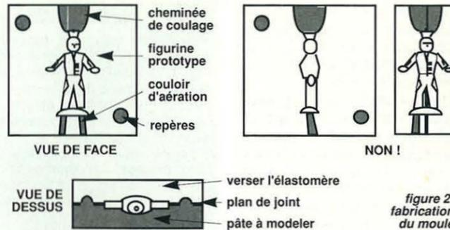
figure 2: fabrication du moule
