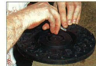
*Le métal en fusion est versé dans la centrifugeuse, et l'on obtient...*
