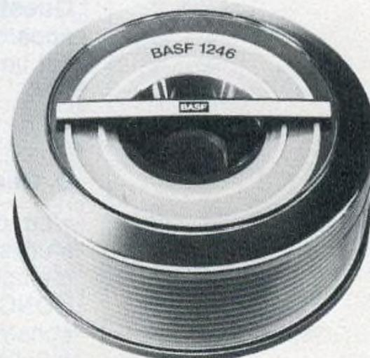
Le « discpack » est un paquet de plusieurs disques empilés. Il est utilisé sur les gros ordinateurs.
