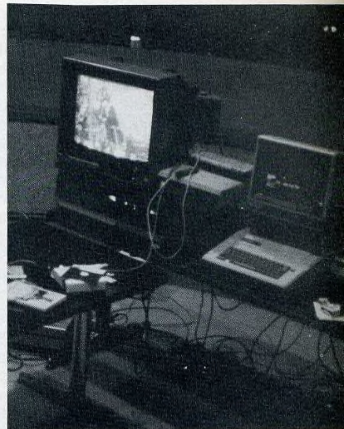
Un vidéodisque, un écran de TV, une interface graphique et un Apple : c'est le système interactif, tel qu'il existe dans le laboratoire du Centre Mondial de l'Informatique.
