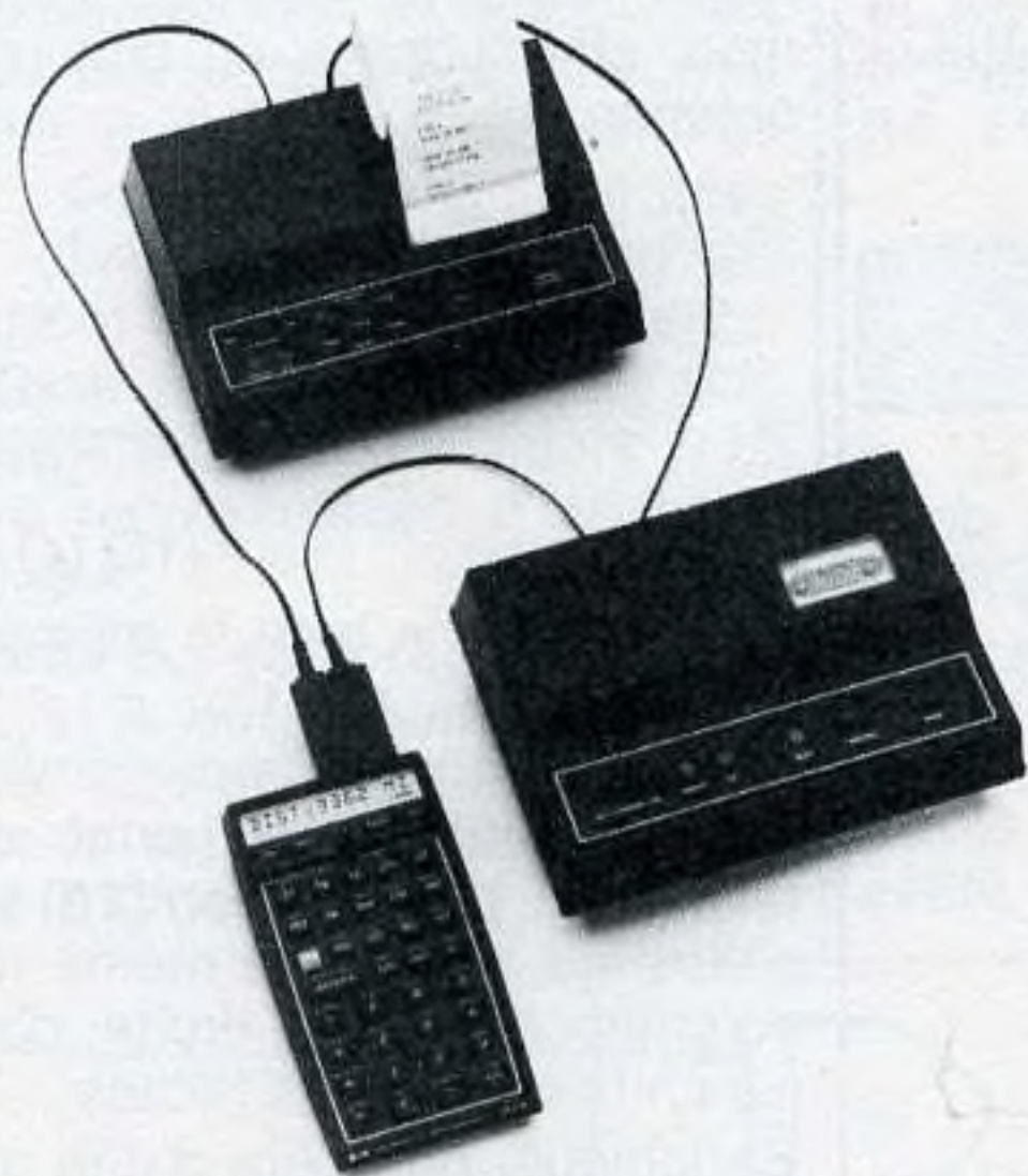
Ordinateur de poche HP-41 CV avec imprimante thermique HP 82162 A et lecteur de cassette HP 82161 A.
