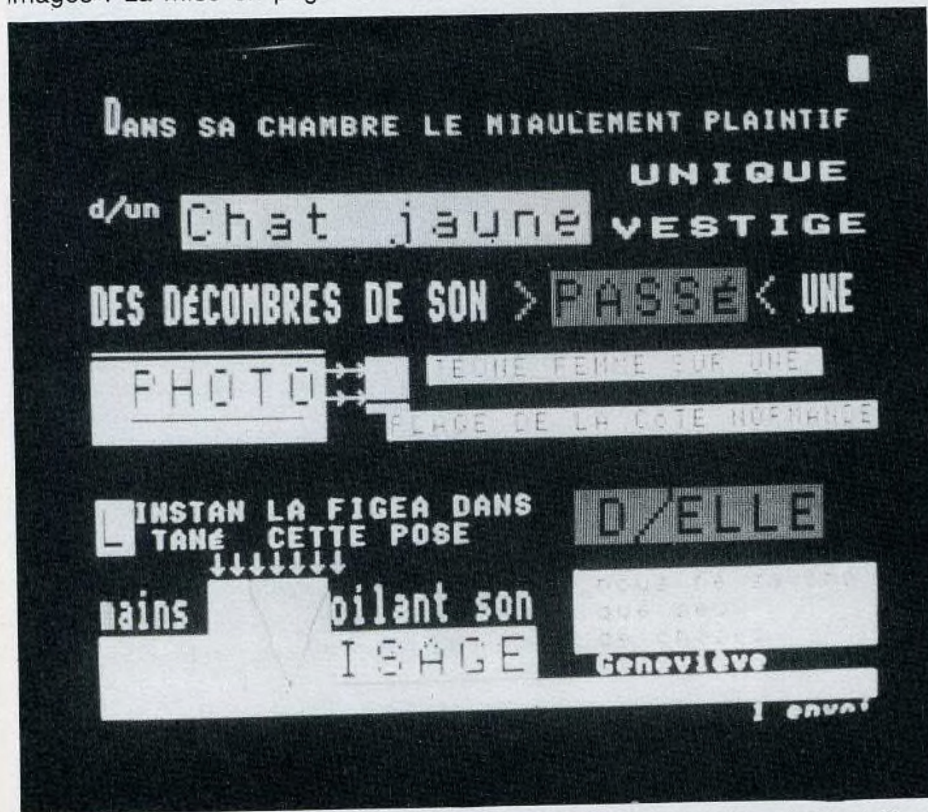
Utilisation des particularités du vidéotex comme les inversions de fond et les doubles tailles de lettres.
