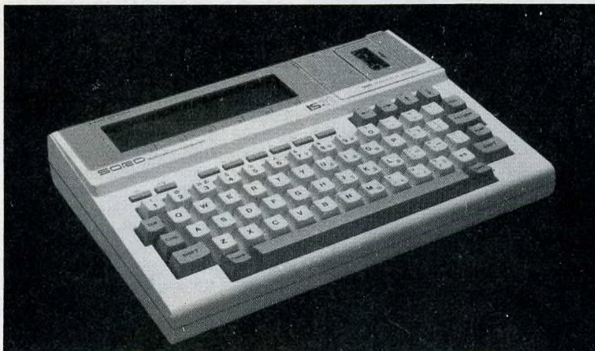
Sord IS 11 :: 64 k Rom extensible à 128 k. Clavier Azerty. 8 lignes de 40 caractères Micro-cassette. Interface RS 232C, interface pour clavier-numérique de porté, interface code à barres. 8 000 F HT.
