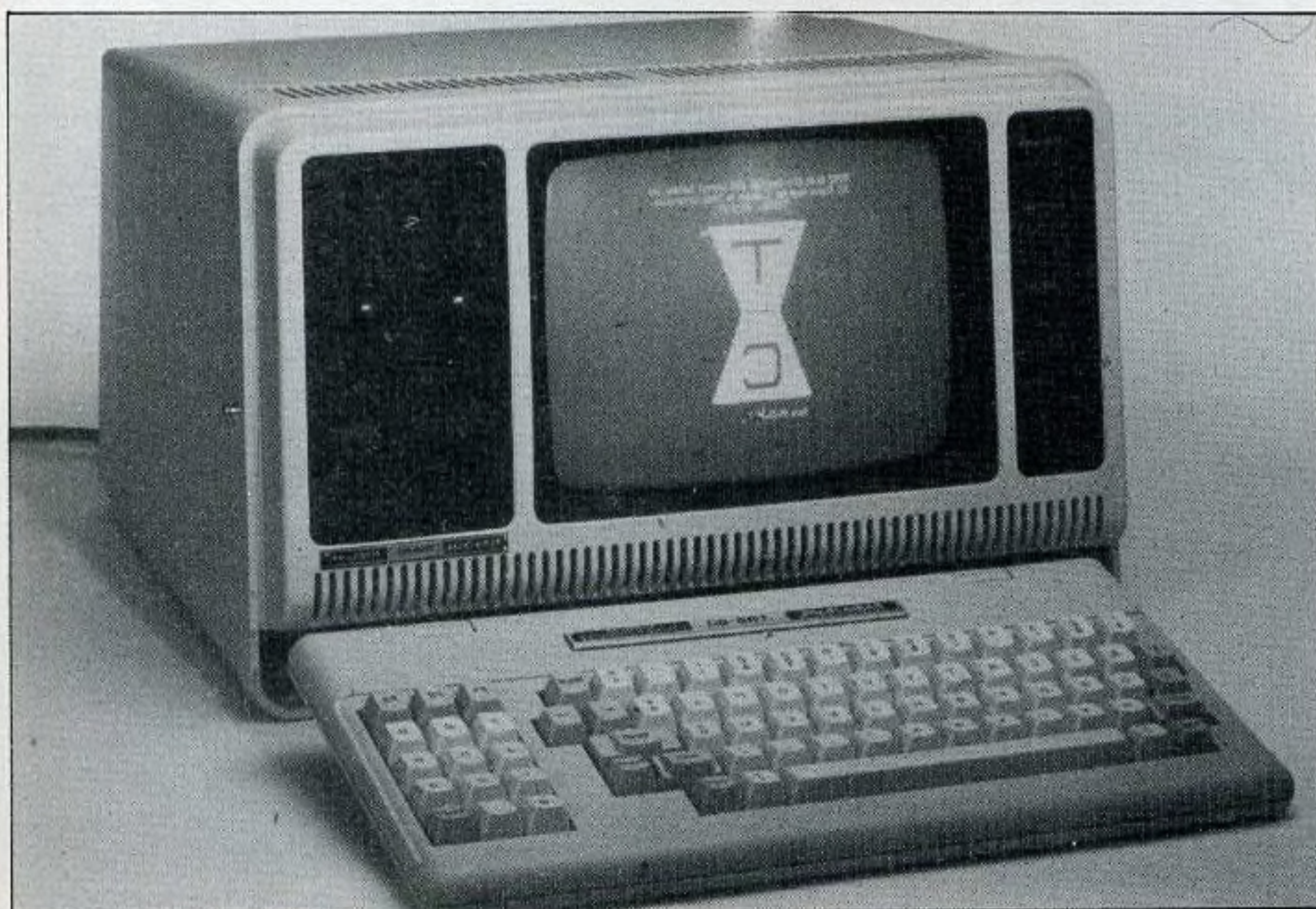
TRS-80 modèle 4P : 64 k extensible à 128 k. Interface RS 232C. 2 unités de disquettes 5,25 pouces. Moniteur de 23 cm. Clavier Azerty. 12 kg. 18 495 F TTC.
