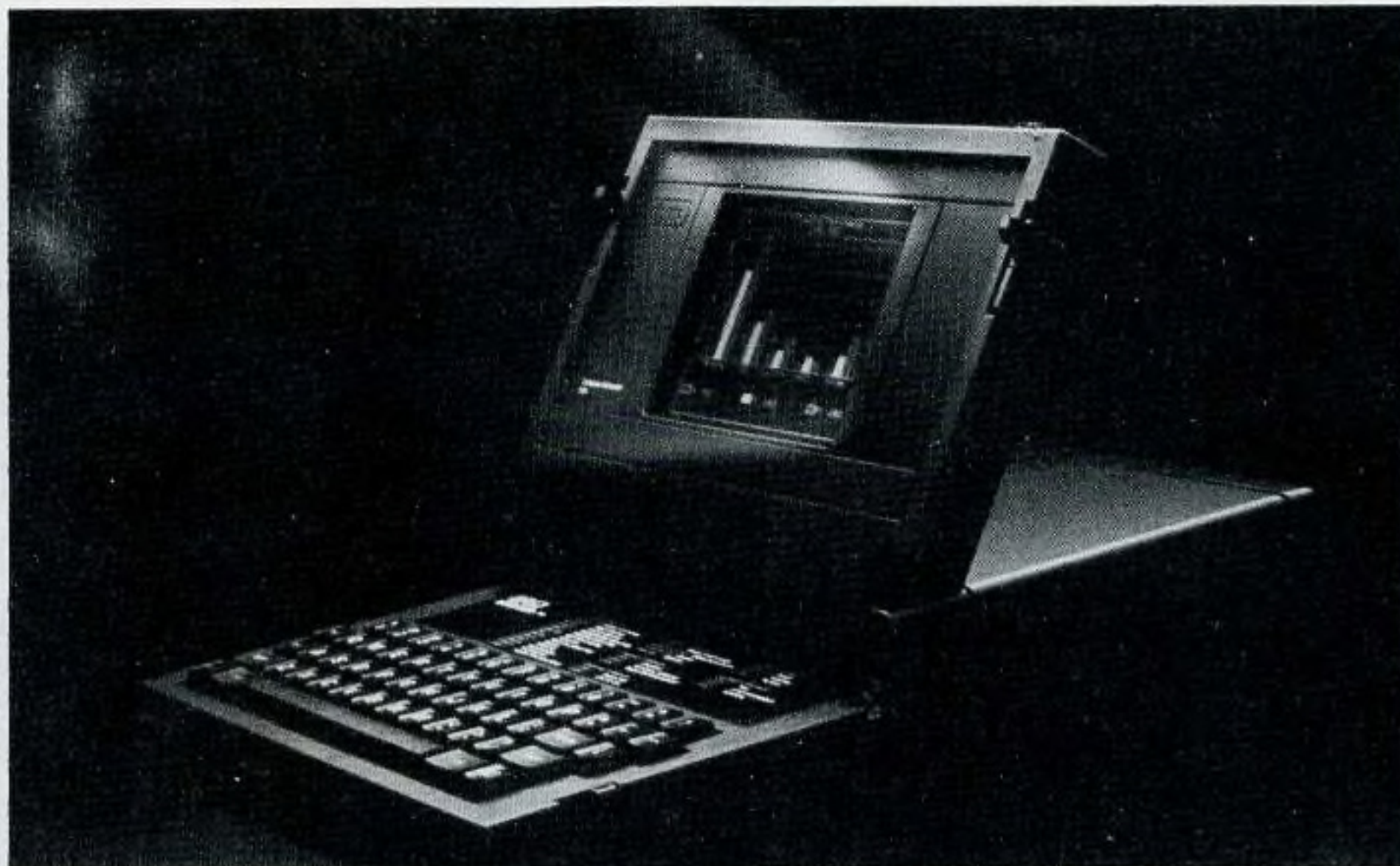
Grid Compass : bi-processeur 80.86 et 80.87. 256 ou 512 ko Ram. 340 ko de mémoire à bulle. 25 lignes de 80 caractères. 4,6 kg.
