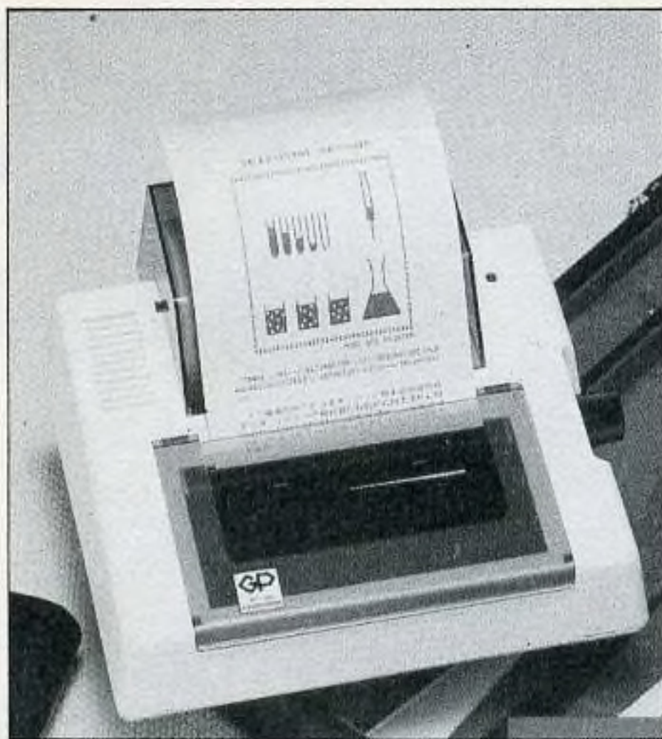
Seiksha 6P.50A : 40 caractères/seconde. 46 colonnes. Copie multiple. Papier en rouleau de 127 mm. Interface parallèle Centronics.
