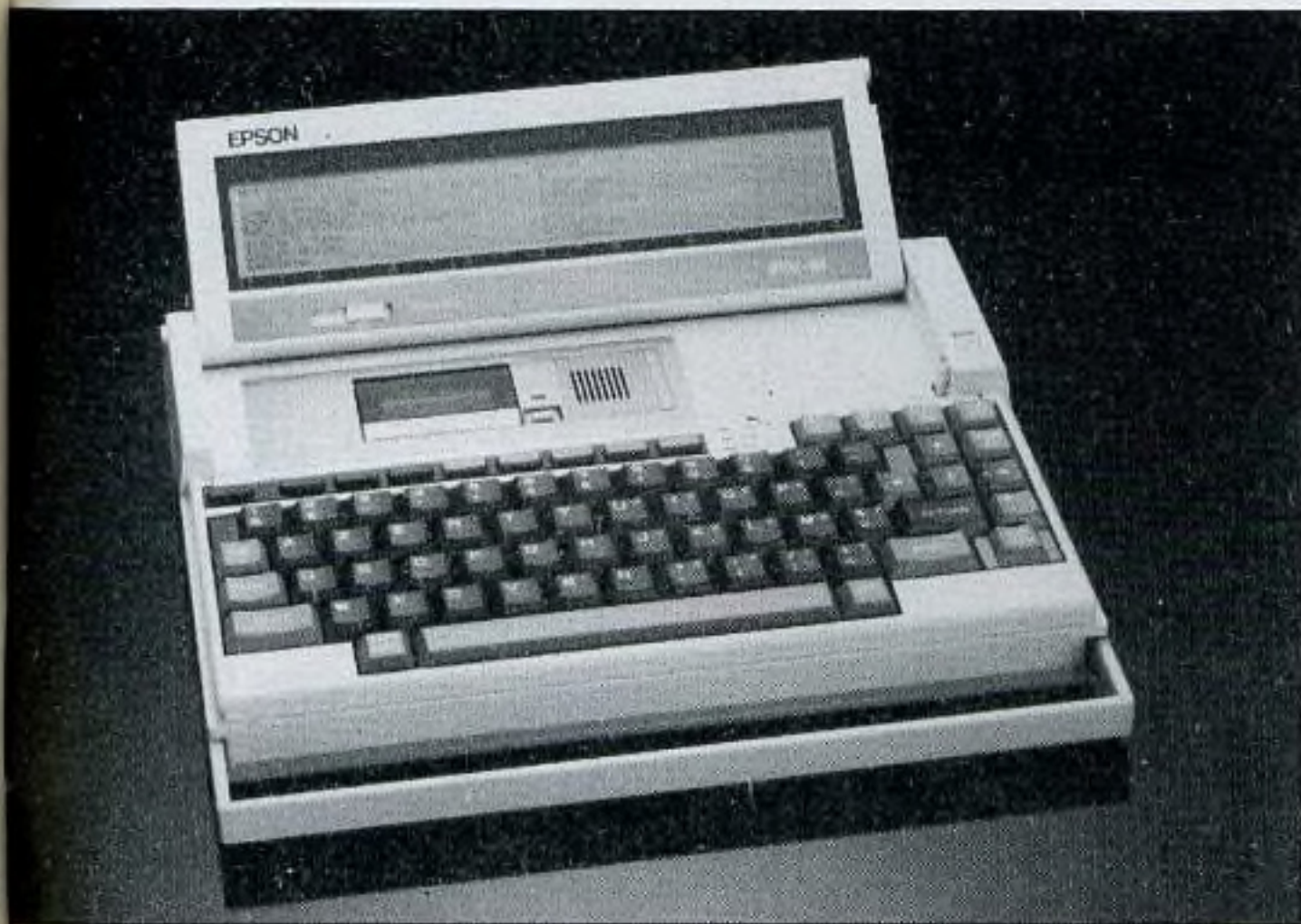
Epson PX-8 : Ram : 64 ko. 8 lignes de 80 caractères. Clavier Azerty. CP/M. Autonomie de 10 heures. Logiciels intégrés sous forme de Rom. Basic Microsoft. 8 960 F HT.
