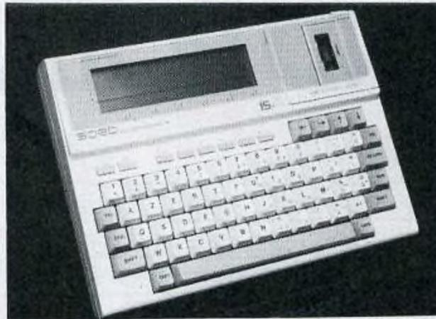
Le Sord IS 11 est le premier portable sans Basic. L'utilisateur n'a pas à se préoccuper de la programmation, ni du langage spécifique, grâce aux logiciels câblés.
