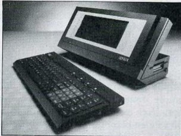
vocale. Il est construit autour d'un processeur Intel 8086, dispose de 256 K Ram d'une unité de disquettes 3" 1/2 de 720 K chacune. Il ne pèse que 6 kg.
