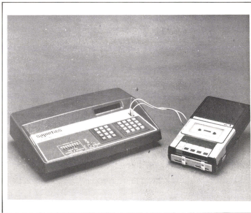
Le micro-ordinateur « Instructeur 50 » est conçu autour d'un microprocesseur 2650 de Signetics. Le magnétophone à cassette sur lequel il est possible de recopier des programmes est du type « audio ».
