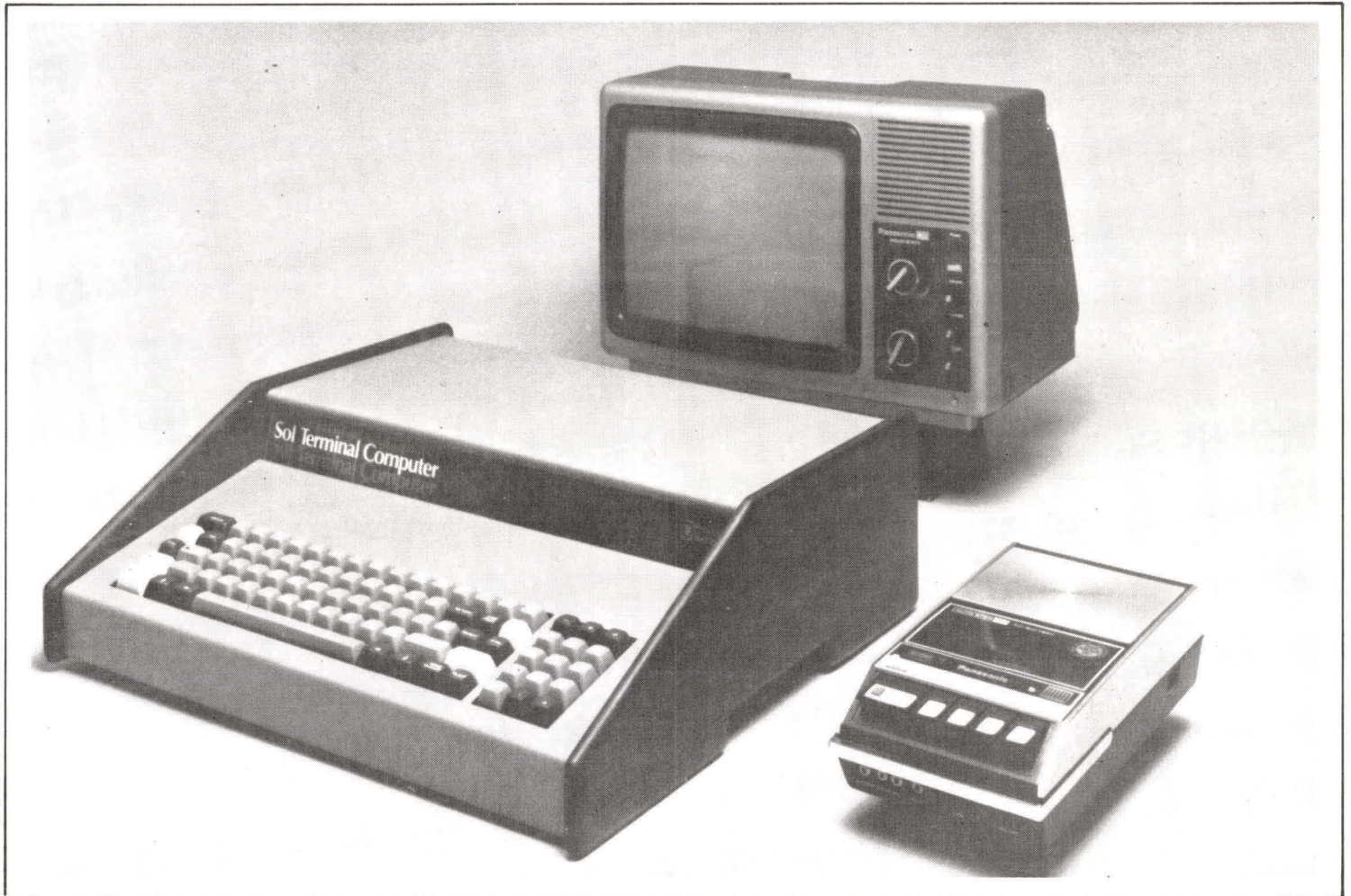
Photo 1. - Un système individuel type comme celui représenté ci-dessus comprend : un boîtier qui inclut le micro-ordinateur et le clavier, un poste de télévision domestique et un simple magnétophone à cassettes pour le stockage des programmes (Doc. Sybex).
