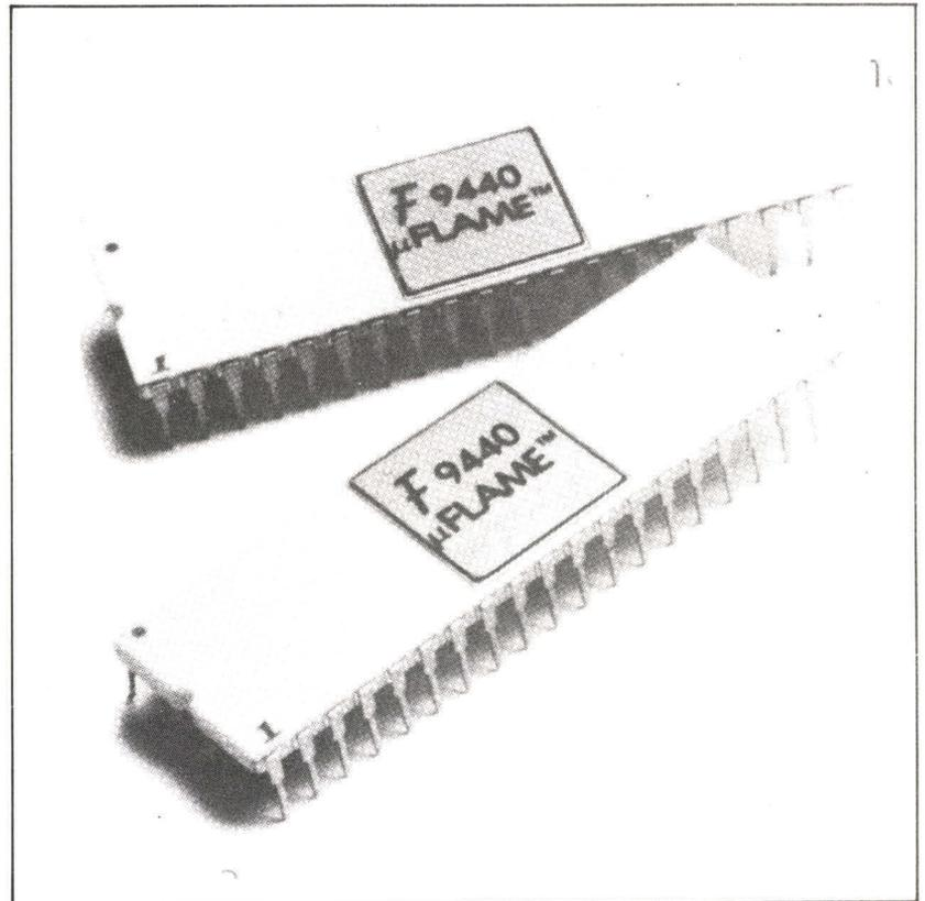
Photo 7. - Le Microflamme 9440 de Fairchild : un microprocesseur 16 bits qui exécute le jeu d'instructions de la ligne Nova de DATA General.
