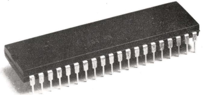
micro-contrôleurs (micro-ordinateurs complets) en un seul boîtier (Texas TMS 1000, Rockwell PPS4-1). Ils sont bien adaptés aux traitements décimaux (calculatrices, terminaux point de vente) : un chiffre BCD se code en 4 bits, mais ils ont, en fait, été complètement supplantés par les 8 bits qui, par suite de leur baisse de prix, ne reviennent pas plus cher.
