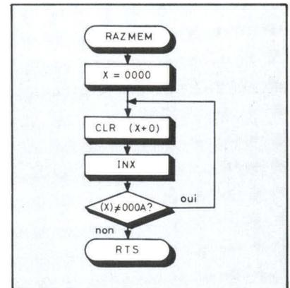
Fig. 6 c. - Sous-programme de remise à zéro des drapeaux. Le contenu des cases mémoires d'adresses A04C à A05F sont mis à zéro.
