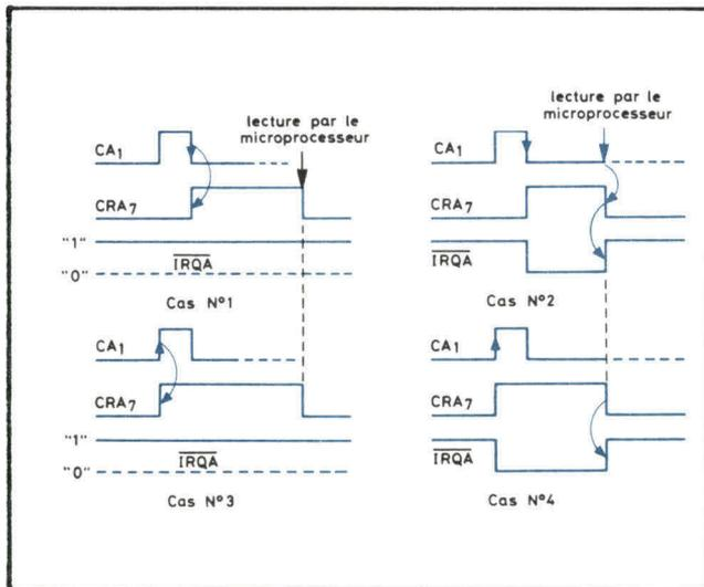
Fig. 13. - Modes de fonctionnement des lignes d'interruptions.
