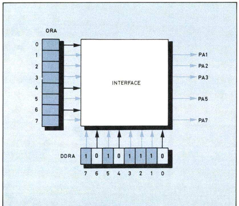
Fig. 7 a. - Seuls les bits 1, 2, 3, 5 et 7 du registre OR A sont transmis à la périphérie (DDRA = 1) sur les lignes PA<sub>1</sub>, PA<sub>2</sub>, PA<sub>3</sub>, PA<sub>5</sub> et PA<sub>7</sub> où ils restent disponibles en permanence car ils sont mémorisés en OR A.
