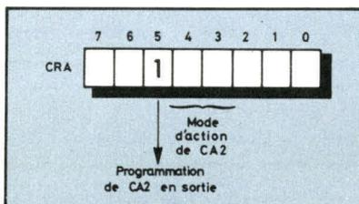
Fig. 14. - L'écriture d'un 1 dans CRA<sub>5</sub> permet la programmation en sortie de commande de CA<sub>2</sub>. Les modes d'action de CA<sub>2</sub> sont alors définis par CRA<sub>3</sub> et CRA<sub>4</sub>.
