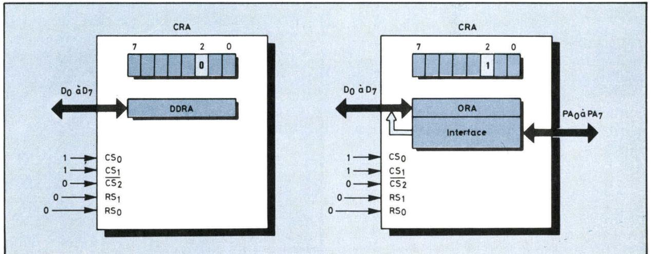
Fig. 5 b. - Si RS<sub>0</sub> = RS<sub>1</sub> = 0, on adresse soit ORA soit DDRA en fonction du bit 2 écrit dans CRA. Si ce bit est à 0, le registre adressé est DDRA et s'il est à 1 le registre ORA est adressé.
