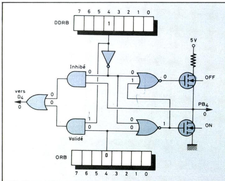
Fig. 11. - Schéma électronique du système lors d'un transfert de données des lignes programmées en entrées. Le bit n° 3 de DDRB étant à 0, le contenu du bit 3 de ORB est transmis vers D<sub>3</sub>.
