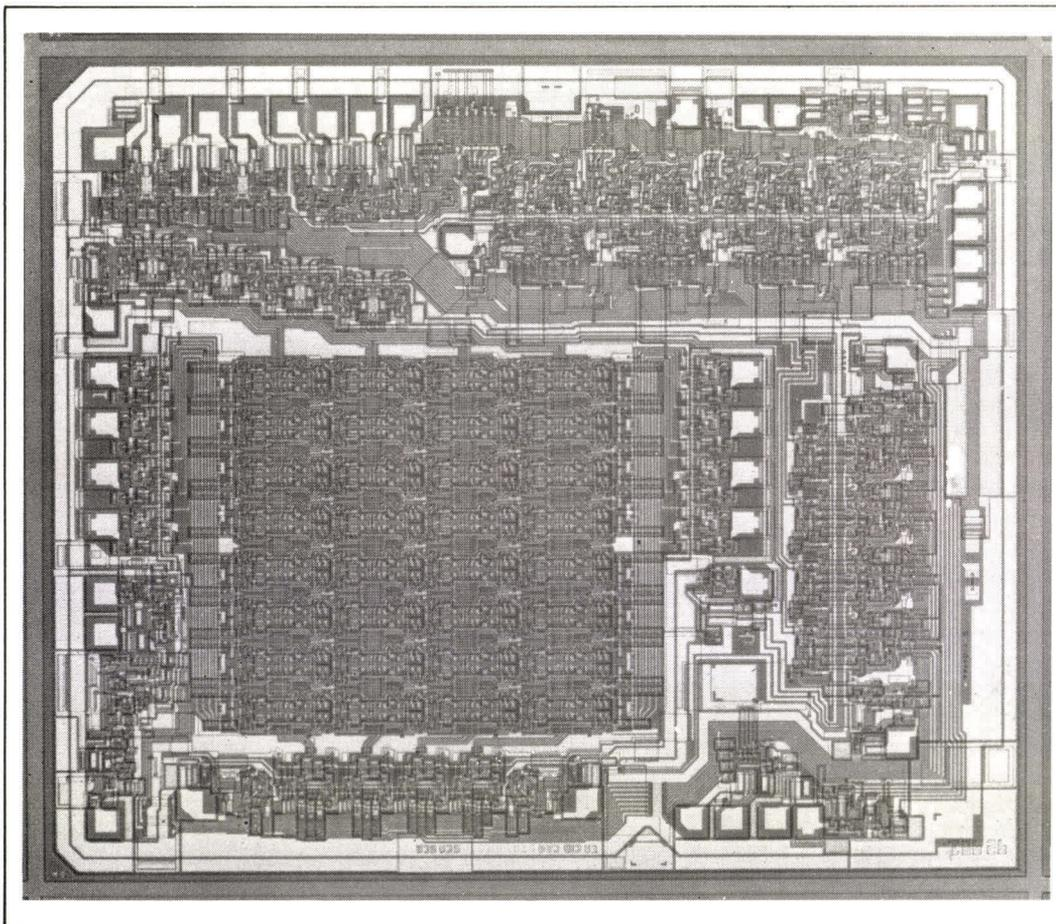
Photo 8. - Réalisé en technologie bipolaire, le SF.C 92901 est un microprocesseur rapide qui traite des mots de 4 bits (cliché Thomson-CSF).
