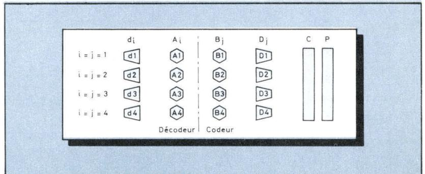
Fig. 3 a. -  $A_2 = B_2$ . En comparant les positions de même rang, on positionne donc les drapeaux  $d_2$  et  $D_2$  à 1. P prend alors la valeur 1.
