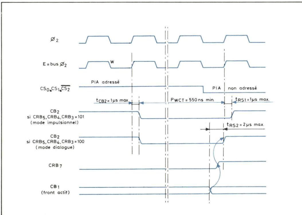
Dans le mode programmé, la sortie CB<sub>2</sub> suit la programmation du bit CRB<sub>3</sub> du registre CRB.
