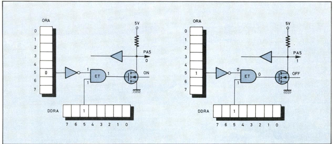
Fig. 8 a. - Les bits à 0 de DDRA permettent de programmer en entrées les bits correspondants des lignes PA<sub>i</sub>.
