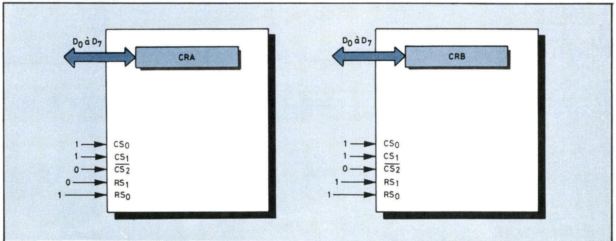
Fig. 5 a. - Les registres CRA et CRB sont adressés directement grâce aux deux fils RS<sub>0</sub> et RS<sub>1</sub>.
