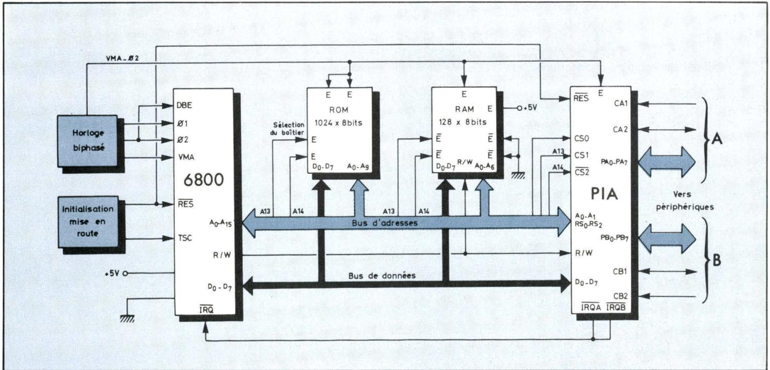
Fig. 1. - Système minimum conçu autour des éléments de la famille 6800.
