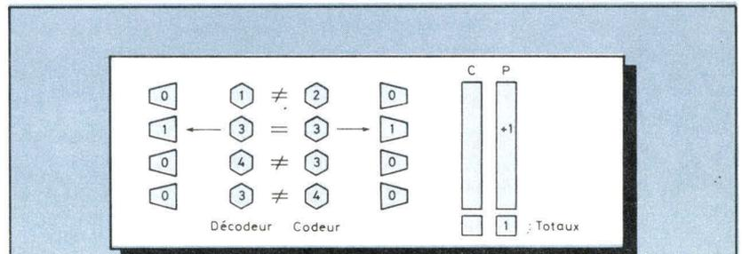
Fig. 3 b. - Après avoir comparé chaque  $A_i$  à chaque  $B_j$  pour lesquels les drapeaux étaient à 0; on obtient C = 2 et P = 1. Cela signifie deux chiffres corrects et mal placés et un chiffre correct et bien placé.
