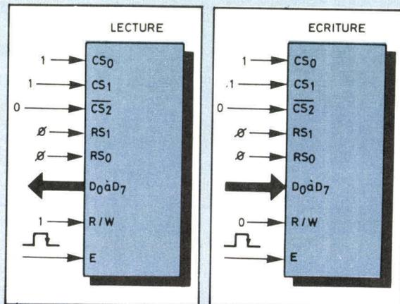
$\left. \begin{matrix} D_0 \\ D_7 \end{matrix} \right\}$  Bus bidirectionnel de données. Il aboutit, dans le PIA, à un amplificateur qui peut être activé ou mis dans l'état haute impédance par le signal R/W si le PIA est sélectionné.
