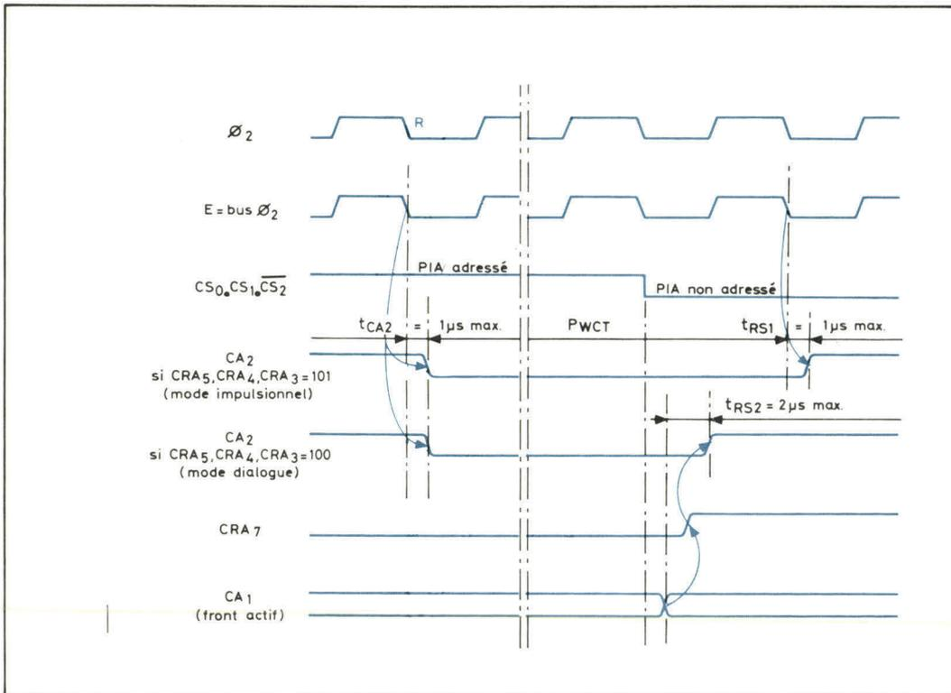
Fig. 15. - Diagramme des modes impulsions et dialogue de CA<sub>2</sub>. Pour ces modes, CA<sub>2</sub> est associé à une lecture.
