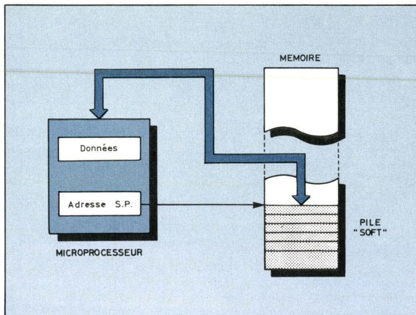
Fig. 3. - Afin de permettre un empilement rapide des informations le registre S.P. pointe toujours le mot situé juste au-dessus du dernier mot déposé.
