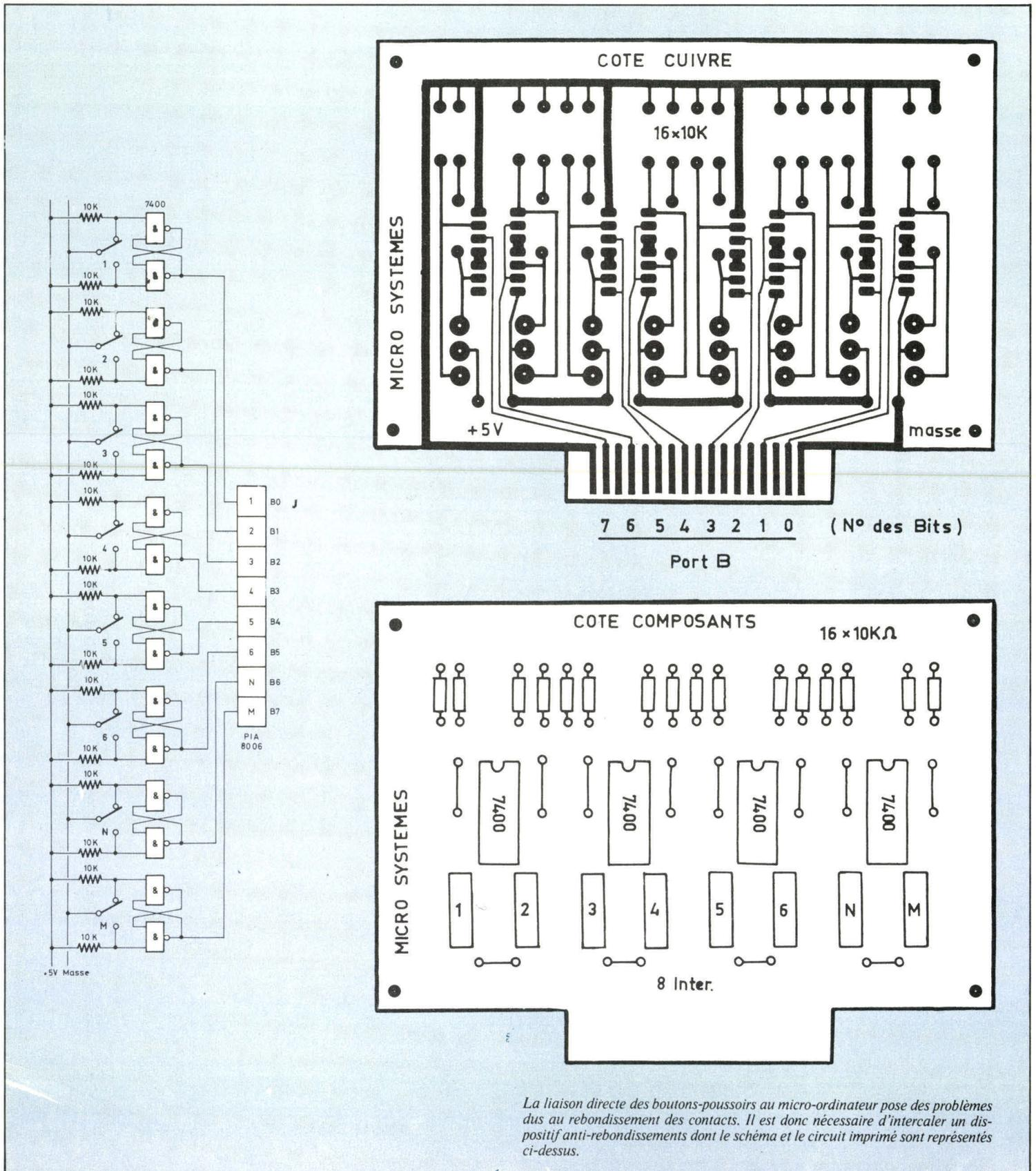
La liaison directe des boutons-poussoirs au micro-ordinateur pose des problèmes dus au rebondissement des contacts. Il est donc nécessaire d'intercaler un dispositif anti-rebondissements dont le schéma et le circuit imprimé sont représentés ci-dessus.
