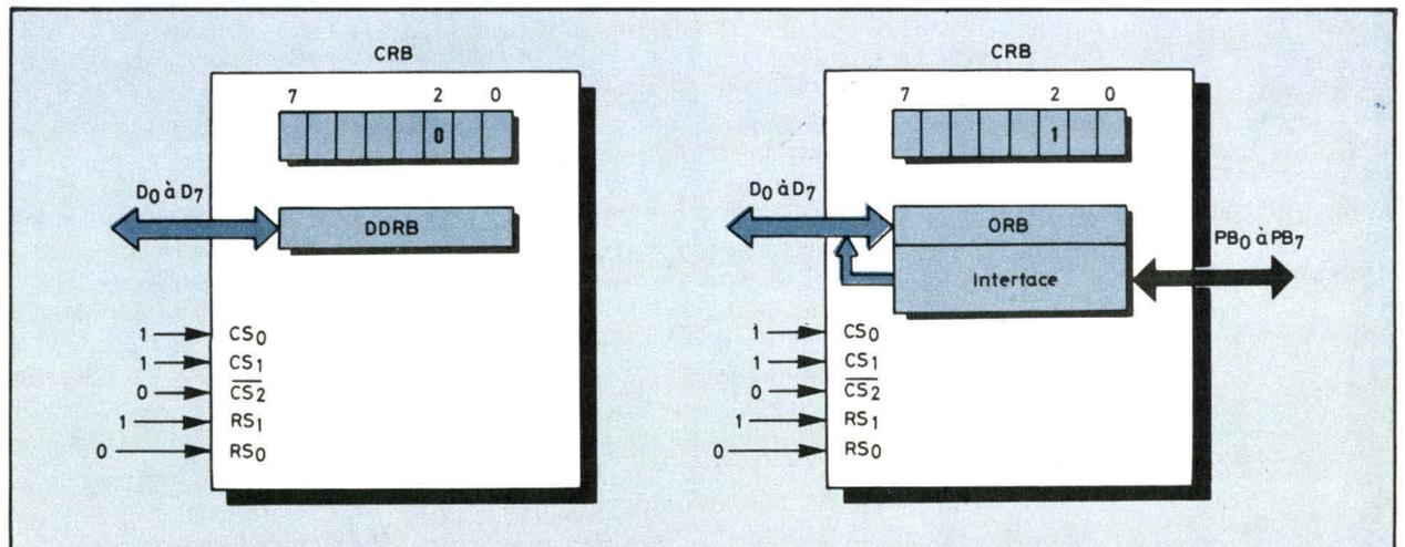
Fig. 5 c. - Lorsque RS<sub>0</sub> = 0 et RS<sub>1</sub> = 1, on adresse soit DDRB soit ORB en fonction de l'état du bit 2 de CRB. Si ce bit est à 0, le registre adressé est alors DDRB; s'il est à 1, c'est le registre ORB qui est adressé.
