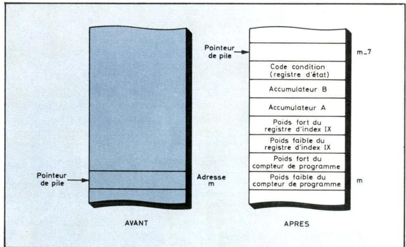
Fig. 5. - Sauvegarde du contenu des différents registres internes du 6800 dans la pile lors d'une interruption.
