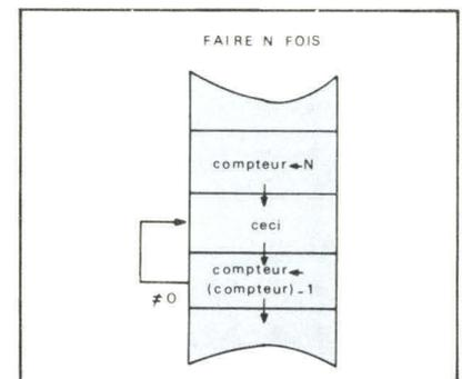
Fig. 8. - Un compteur est chargé avec la valeur N. Puis le programme fait « ceci » jusqu'à ce que les soustractions successives de 1 du compteur donnent zéro. Ce schéma, très utilisé, peut être par exemple celui d'une boucle de temporisation.
