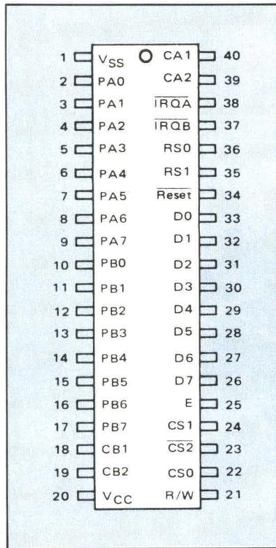
Fig. 3. - Le P.I.A. communique entre le système et la périphérie à l'aide des signaux indiqués. Remarquez les borniers A (PA<sub>0</sub> à PA<sub>7</sub>) et B (PB<sub>0</sub> à PB<sub>7</sub>) ainsi que leurs lignes de dialogue associées (CA<sub>1</sub>, CA<sub>2</sub>,  $\overline{IRQA}$ ) et (CB<sub>1</sub>, CB<sub>2</sub>,  $\overline{IRQB}$ ).
