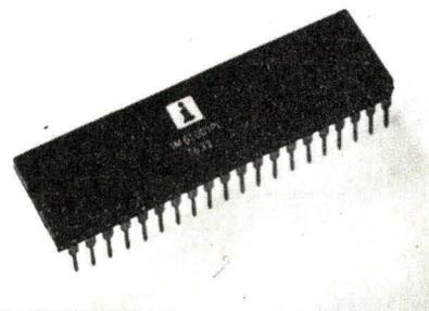
Photo 2. - Microprocesseur 12 bits en technologie C.MOS : le 6100 de Intel.
