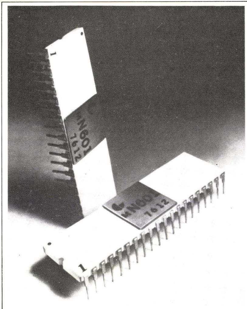
Photo 4. - Le noyau de la famille d'ordinateur micro NOVA est le microprocesseur mN601 de 40 broches fabriqué par DATA General dans son usine de Sunnyvale en Californie.
