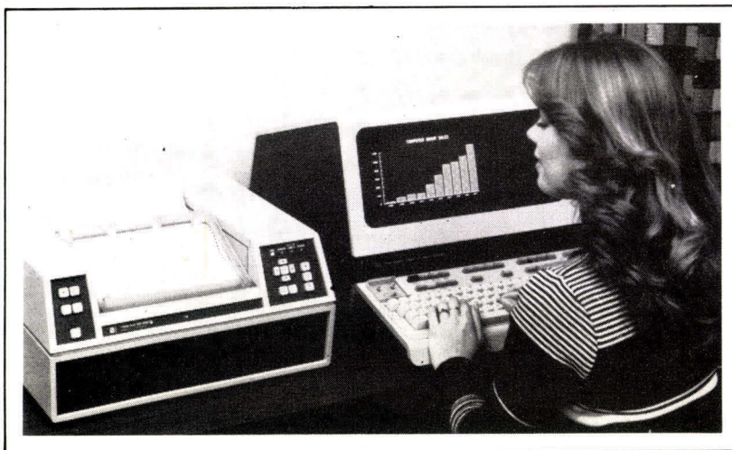
Photo 2. - Dans le cas d'un travail de conception, une sortie imprimée de haute qualité peut être assurée par une imprimante du type HP 7245 A.
