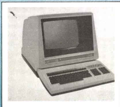
Fournissant une image de 320 x 240 pixels adressables, et une palette de 35 couleurs différentes, cet ensemble microprogrammé est constitué d'un moniteur RVB de 17 pouces, d'un clavier opérateur et d'un contrôleur possédant 2 mémoires, l'une alphanumérique et l'autre graphique.
