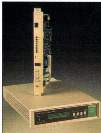
Il supporte le CCITT V32 bis, V32, V23, V22, V22 bis et V21 sur support réseau téléphonique commuté, ou liaison spécialisée (2 ou 4 fils). De plus, les protocoles de compressions et de corrections d'erreurs V42 et V42 bis permettent un débit maximum de 57,6 Kbits/s. Prix: 10000 F HT; T&T (94262 Fresnes).
