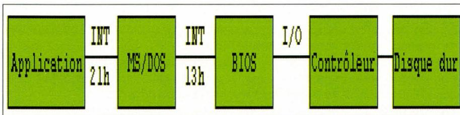
Figure 2 - Accès disque sous MS-DOS.
