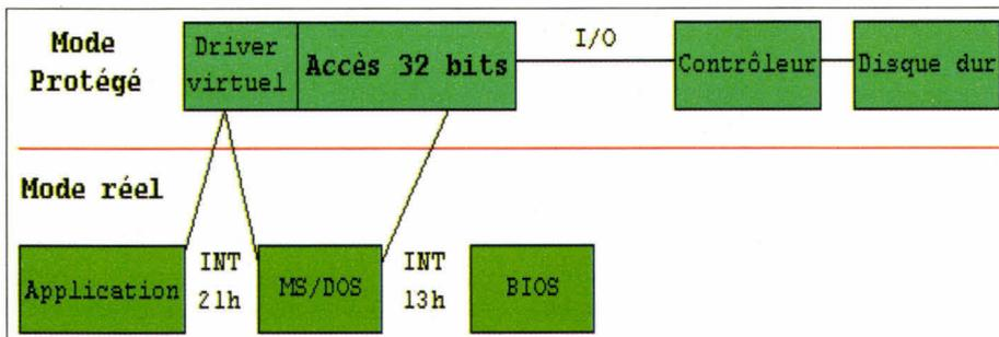
Figure 4 - Accès disque 32 bits sous Windows 3.1.
