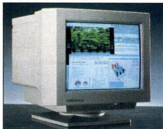
automatique de la géométrie de l'affichage, ainsi que le contrôle des couleurs et de la consommation. Le concept "large vision" exploite la surface totale du tube de 17" à coins carrés et affiche une résolution de 1280x1024 en mode non-entrelacé pour une vitesse de rafraîchissement de 70 Hz avec les contrôleurs graphiques AA51/1c51 ou MD-B 12 (en option). Prix: 13900 F HT; Incoma (92230 Gennevilliers).
