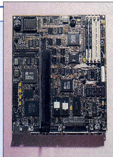
*Photo A - Le DeskPro 386/33L (à gauche) contient une grande carte système double face à huit couches, une alimentation spécifique et beaucoup de place pour les extensions. Le nouveau ProLinea (à droite) est un système ISA plus petit basé sur une carte quatre couches plus petite et simple face, fonctionnant grâce à une alimentation standard.*
