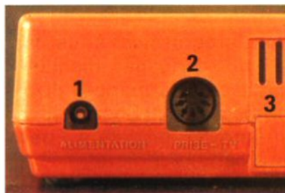
L'alimentation électrique (1) ; la prise TV (2) ; le connecteur d'extension mémoire (3) ; le bouton de remise à l'état initial (4) qui est utilisé quand l'ordinateur se bloque ; l'entrée et sortie en série (5) qui permet de brancher une imprimante série ; la prise cassette (6).
