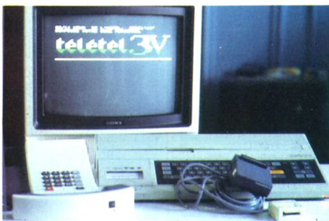
La prise DIN 5 broches ne sert qu'au lecteur-enregistreur de programmes Thomson, pour améliorer la fiabilité des enregistrements et des lectures.
