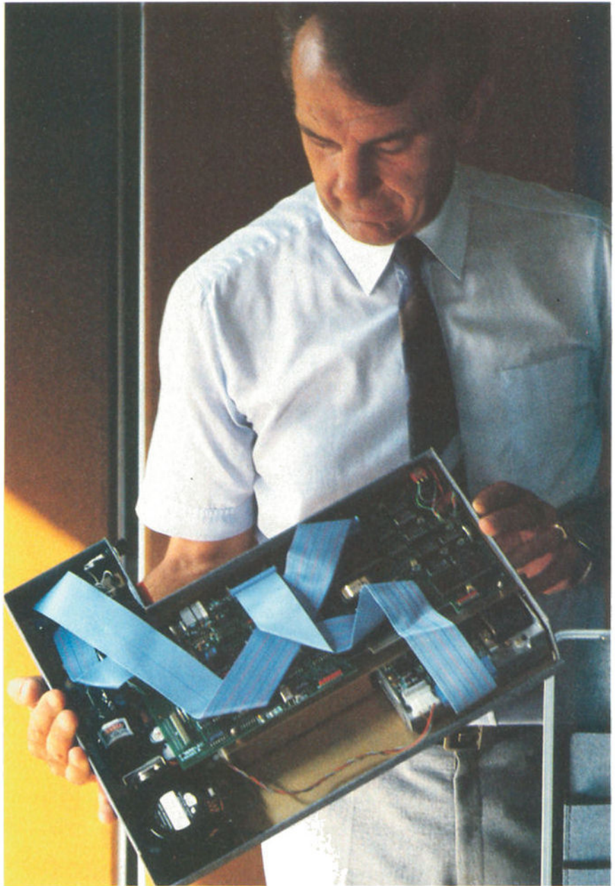
Marcel Richard, patron de Sobrelec et la carte du Portel. Ce micro professionnel de 64 K en version standard, est livré dans un attaché case. Pratique, il se connecte sur un écran minitel ou un terminal vidéo série banal.
