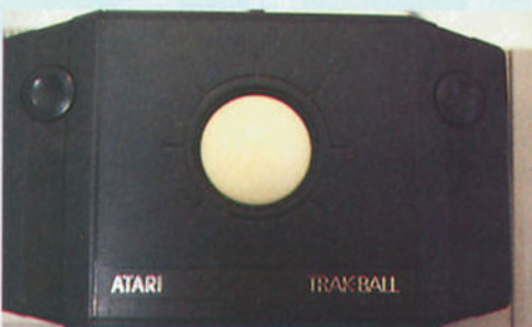
Une nouvelle gamme de périphériques accompagne la sortie des nouveaux Atari : des imprimantes, une table graphique et un track-ball (ci-contre) qui peut remplacer un Joystick.
