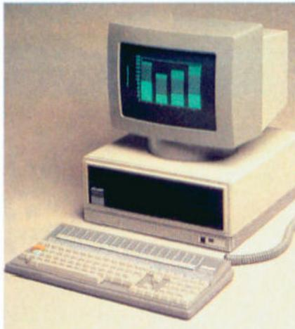
Ram pouvant être étendue à 640 K octets. Le « M 24 » peut utiliser quatre systèmes d'exploitation : le MS-DOS de Microsoft, le concurrent CP/M-86 de Digital Research, le UCSD-P et le PCOS d'Olivetti. Les utilisateurs du modèle « M 24 » disposeront d'une très vaste bibliothèque de programmes d'application. Olivetti distribuera de nombreux progiciels notamment dans le domaine des activités de bureau et de gestion.
