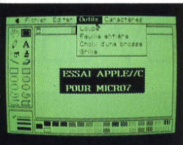
Ci-dessus : le prototype de l'écran plat à cristaux liquides (24 lignes x 80 caractères) qui sera disponible vers le 4 e trimestre 84.
