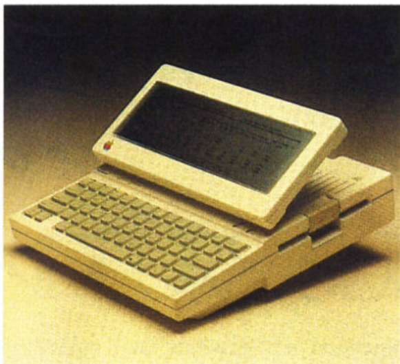
Ci-dessus : le prototype de l'écran plat à cristaux liquides (24 lignes x 80 caractères) qui sera disponible vers le 4 e trimestre 84.
