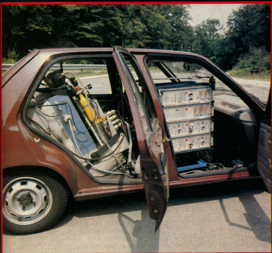
**Maltraitée durant trois mois, cette voiture est sous surveillance électronique. Le robot conduit et détecte également toute défaillance mécanique. Les suspensions, démontées tous les 250 km, sont passées au crible. A la CAO, ensuite de résoudre tous les problèmes de résistance.**
