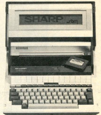
Le SPC-5000 pèse 4,3 Kg, son autonomie est de 8 heures. Il utilise d'autre part, le même système d'exploitation MS-DOS 2.0 que l'IBM-PC, utilisant ainsi un grand nombre de logiciel déjà existant. L'on peut également y connecter, des imprimantes séries (RS-232-C), un lecteur de code à barres, des modems acoustiques (RS-232-C), d'autres ordinateurs tel le 0A-8000 sous UNIX Sharp le SPC devient alors terminal, une interface télex marine branché à une BLU (shipcom), etc.
