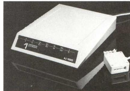
la transmission totalement transparente aux codes et procédures. La liaison de type synchrone autorise la transmission aux vitesses courantes (de 600 à 19.200 bits par seconde). Tél : 657.12.10.
