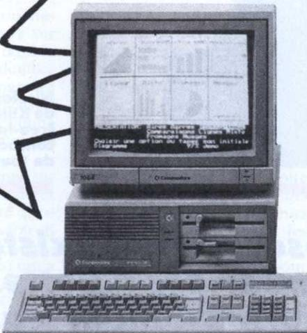
4,77 à 9,54 MHz - 640 Ko de RAM - Interfaces série et parallèle - Disquette 5 1/4 et/ou 3 1/2 - Disque dur 20Mo (PC 20) - 3 Slots d'extension disponibles - Clavier 102 touches - MS/DOS 3.2 - GW BASIC ...
