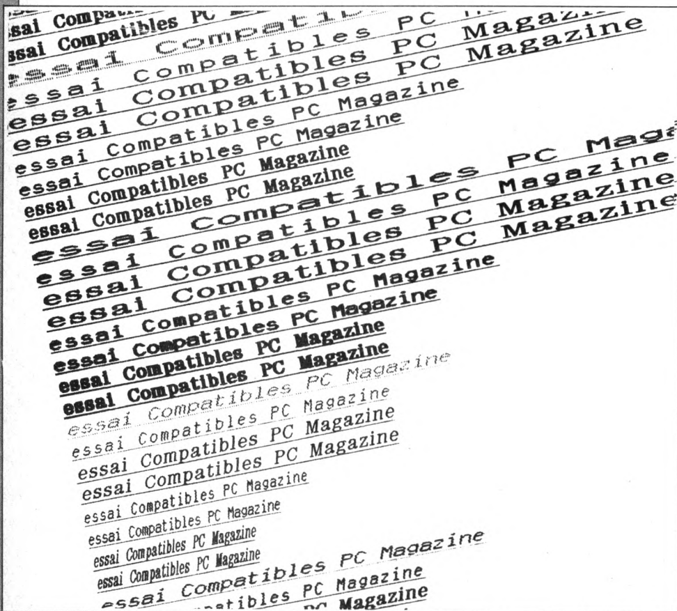
La P2200 conjugue les différents modes : gras, italique, expansé, condensé, souligné, etc.
