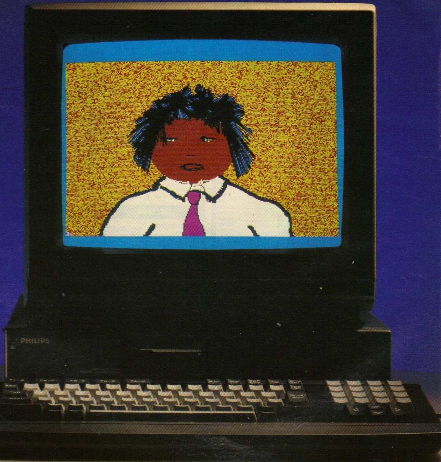
Nouvel élément du concept New Media System de Philips, le NMS 8280 occupe le même créneau que le HBG900 de Sony: le traitement d'images. Intégrant un digitaliseur et de nombreux connecteurs pour les liaisons avec une caméra ou un magnétoscope, la machine se présente de façon similaire au NMS 8250 et 8255. A savoir : boîtier plat de couleur sombre et d'aspect sérieux, clavier mécanique détachable et deux lecteurs de disquette 3 et demi double face sur la face avant.
