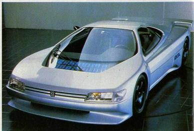
Peugeot aussi était présent avec un prototype nommé *OxiA* : un monstre de 2849 cm<sup>3</sup> suralimenté par deux turbocompresseurs, 24 soupapes et 2 x 2 arbres à cames en tête. Ces caractéristiques sont impressionnantes, mais la véritable innova-
