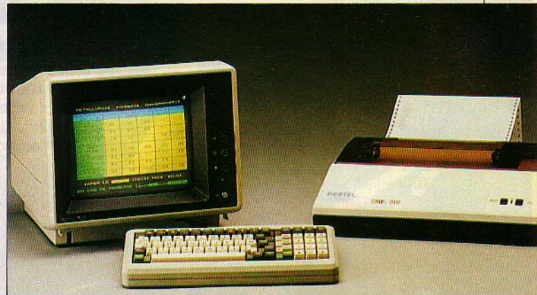
Le terminal Télétel MC 2900 avec imprimante.
