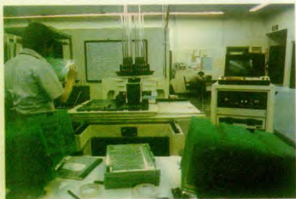
Vérification des plaques vertes des circuits imprimés. Le nombre des contrôles diminue le risque de malfaçon.
