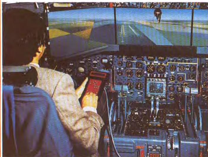
Un boîtier de commande permet de modifier tous les paramètres du vol (ici sur Transall C 160) et de déclencher tempêtes, orages ou pannes...
