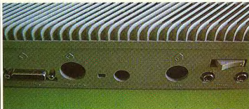
La face arrière du STE dévoile de nouveaux connecteurs. Des sorties son de type Cinch et un orifice Genlock font en effet leur apparition.
