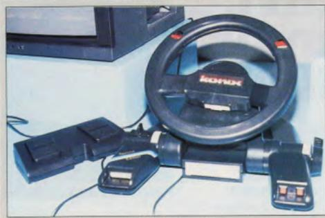
La console Konix est entièrement modulable. Selon le jeu, on peut y adapter le volant d'une voiture, le guidon d'une moto ou le manche d'un simulateur aérienne.
