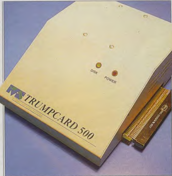
Le boîtier va s'enficher dans le port d'extension de l'Amiga.
