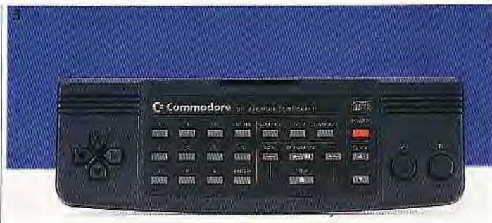
5. Le joystick infrarouge à plusieurs fonctions. Le jeu (flèches de déplacement et bouton de tir) et le transfert du CDTV en CD audio.
