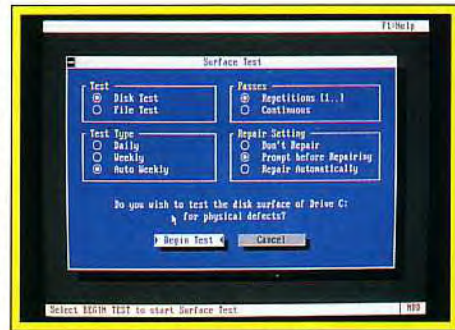
Détection et réparation des pistes défectueuses.
