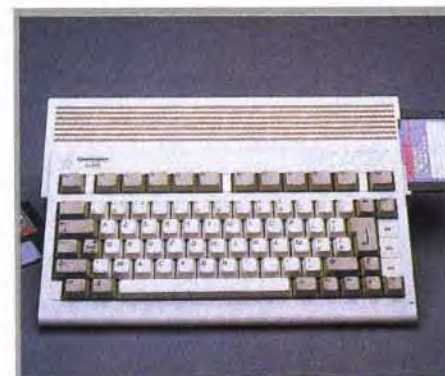
Plus léger, de taille réduite, l'Amiga 600 fait penser à une console avec un clavier.
