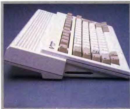
L'Amiga 600 est un 500 modifié et allégé ! Notez ici le port réservé aux cartes mémoires.
