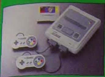
Le microprocesseur de la Super Nintendo est un 68016 à architecture 8-16 bits. En fait, il s'agit d'une version de ce processeur revue et corrigée par Nintendo. Il est épaulé par une batterie de coprocesseurs. Ces précieux alliés, qui ne connaissent pas d'équivalents sur d'autres consoles, ont été développés par la société japonaise pour décharger le processeur central des lourdes tâches de gestion et de calcul inhérentes au bon fonctionnement d'un jeu. Ce sont essentielle-
