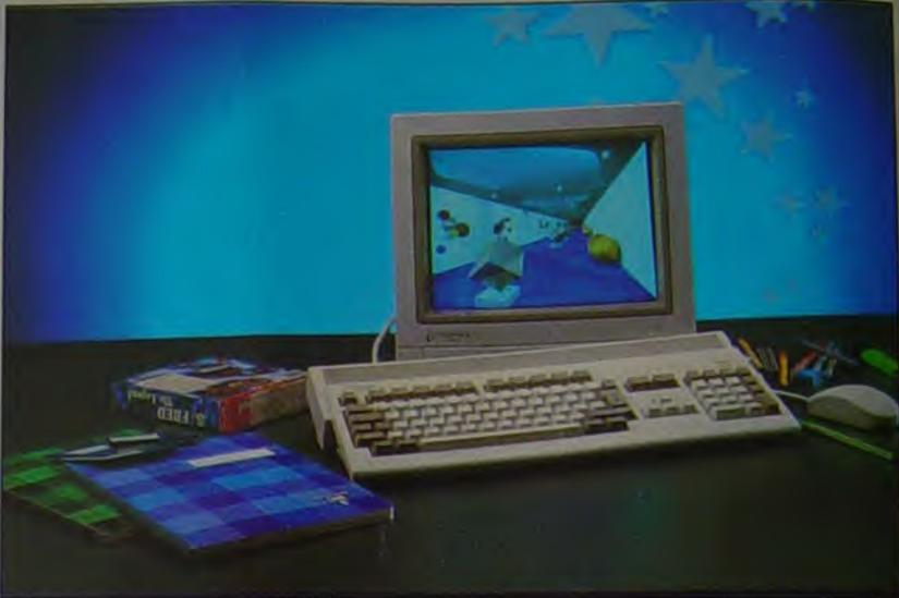
320/640/1280 pixels de large par 256/512/480/960 pixels de haut. Le système d'exploitation (Worbench version 3.0) dispose d'un bon nombre d'améliorations (cf. encadré Amiga 4000), les 2 Mo de mémoire vive permettant aussi de tirer directement parti du multitâche. Le plus incroyable, c'est que ces performances excellentes s'accompagnent d'un prix très abordable : 3 800 F environ.
